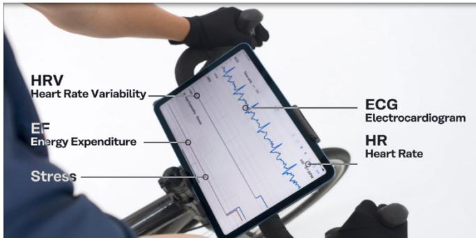
[Foto 1] Mit intelligenten Fahrradhandschuhen aus elektrisch leitfähigem Gewebe, das auf Basis von Kuraray-Fasern entwickelt wurde, lassen sich Vitalzeichen messen. (Quelle: Kuraray)
